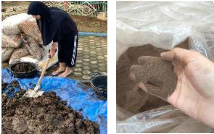
**Gambar 4.** Persiapan bahan baku : pengeringan *sludge* kering dan penggilingan *sludge* menjadi *sludge* halus
