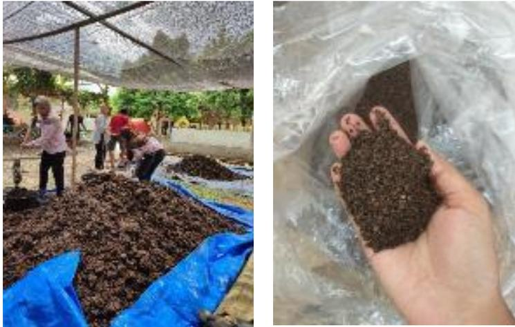
**Gambar 5.** Persiapan bahan baku : pengomposan *sludge*-kulit kopi dan penggilingan kompos
