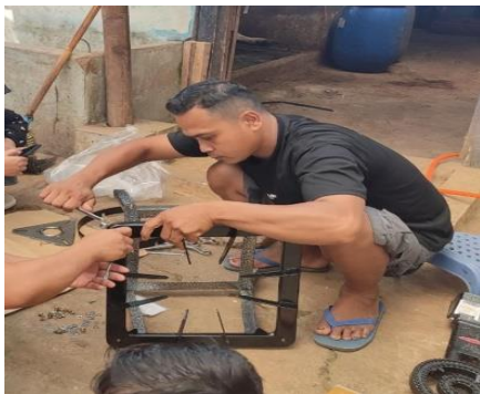
Gambar 15. Perakitan kompor biogas
