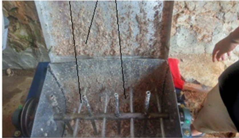
Gambar 4. Hasil suiran daging ikan tongkol pada beban sebesar 1/2 kg dengan waktu penyuiran 10 menit
