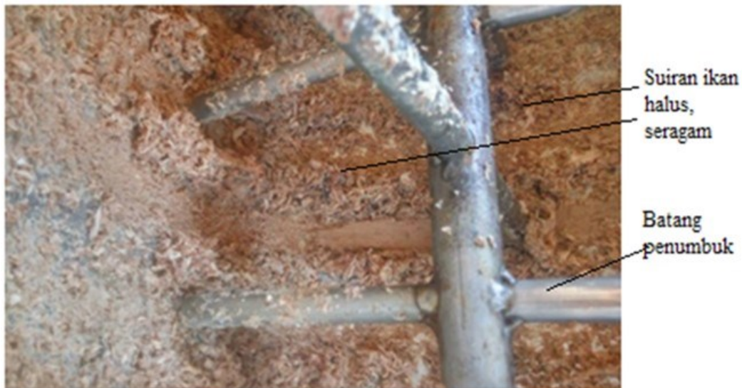
Gambar 7. Daging ikan hasil suiran dengan ukuran seragam dengan kapasitas 1 kg dan waktu penyuiran selama 15 menit
